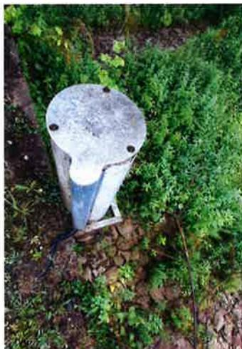
Figure 37. Tube de protection de la sonde de niveau d'eau de l'ouvrage de décharge de la mairie
